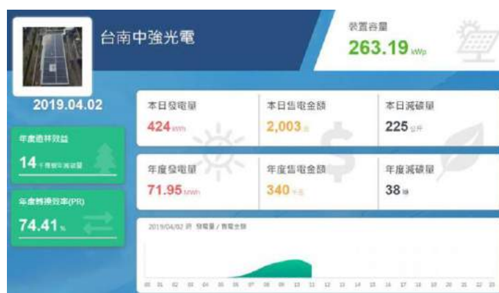
▲南科廠太陽能系統即時監控顯示器
